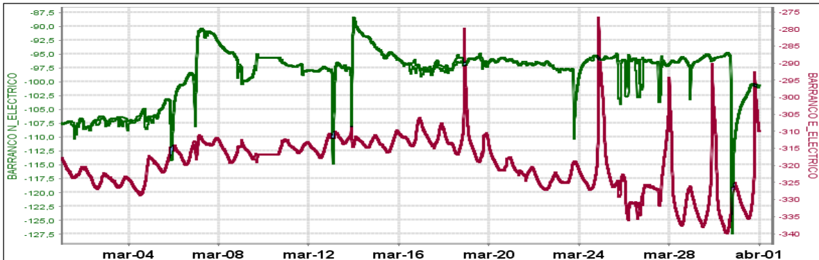
Figura 37. Variaciones del campo eléctrico, en la estación Barranco, perteneciente a la red de monitoreo del volcán Galeras, para el mes de marzo de 2016). Componente NS (verde), EW (roja). La escala de medición del campo eléctrico está en mili voltios.
